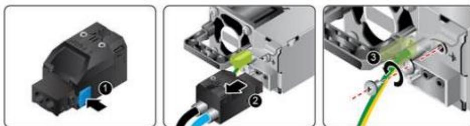
2. 使用十字螺丝刀拧下接地孔连接螺钉，将套在螺钉上的接地线拔下，如图 6-32 中③所示。
