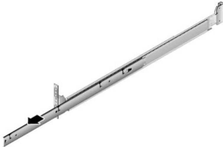
2. 将服务器上的固定钉对准内轨的固定孔位，然后向前推进，直到听见“咔”的一声，确保卡扣弹起完全挡住挂钉，使服务器固定到内轨上，如图 6-11 所示。
