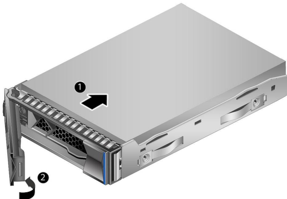
步骤 6 待硬盘扳手已经扣住机箱横梁，闭合硬盘扳手，利用扳手和机箱之间的切合力将硬盘完全推入机箱，如图 6-23 中②所示。
