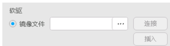
图3-64 通过虚拟软驱挂载镜像文件
